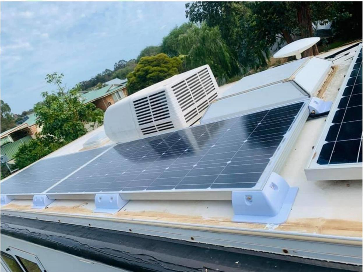
Apriete los tornillos y asegúrese de que estén apretados. Aplique adhesivo de bloqueo de tornillos a la rosca del tornillo, luego los tornillos se pueden aflojar incluso si son muy fuertes.
