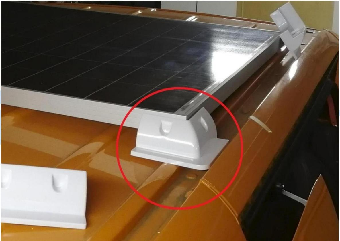
Utilice el rotulador para marcar con cuidado en los soportes de las esquinas la forma de las ondas que debe recortar para el techo de su autocaravana.
