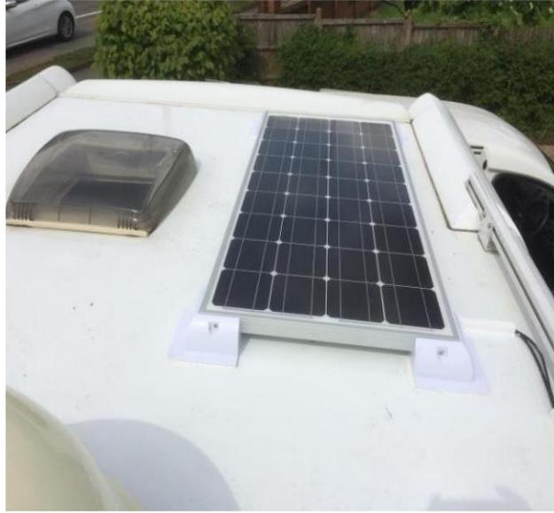
Perfore la abertura a través del techo para acomodar los cables, pero sólo lo suficientemente grande como para que la abertura se extienda a través del casquillo del eje hasta el controlador de carga y el módulo solar; No conecte todavía los cables al módulo solar.
