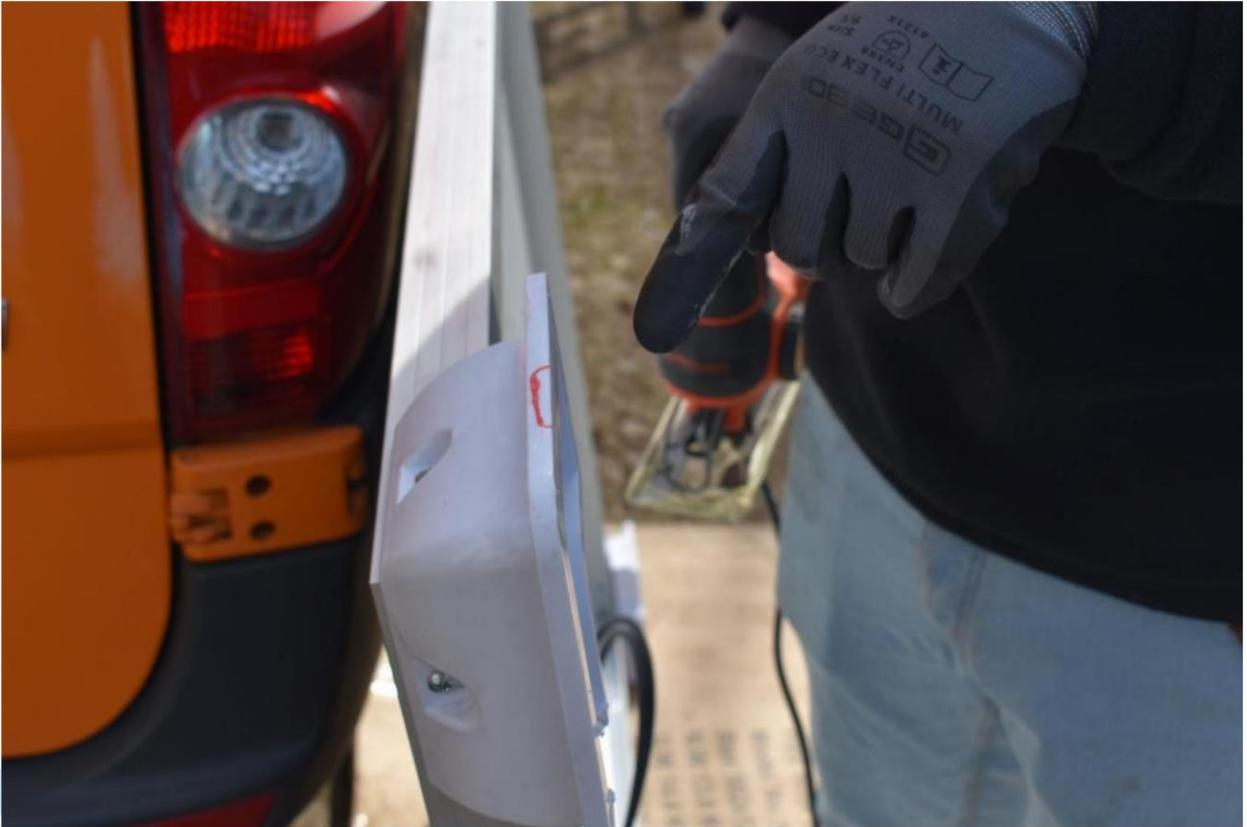
Recortar con cuidado los soportes con una sierra de calar siguiendo la línea dibujada anteriormente. Una hoja de metal ayuda a realizar un corte preciso.
