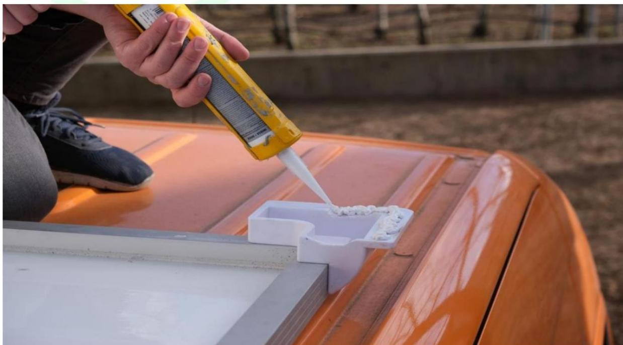
Si algunas ranuras son demasiado profundas, puede nivelarlas con una o más capas de cinta de butilo (con Sikaflex en la parte superior e inferior).
