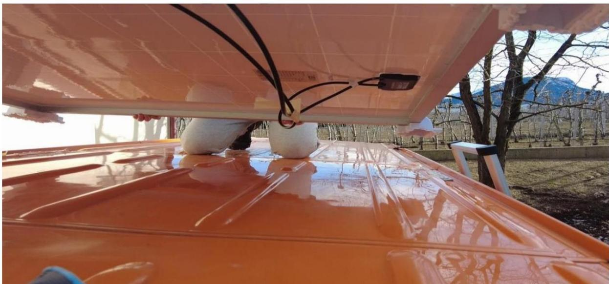
Cuando se hayan colocado todos los paneles, rellene los restantes Espacios entre los soportes y el techo de su Transportadores con pegamento. Retire el exceso de pegamento con toallas de papel y deje que el pegamento actúe durante al menos 24 horas (mejor 48 horas).
