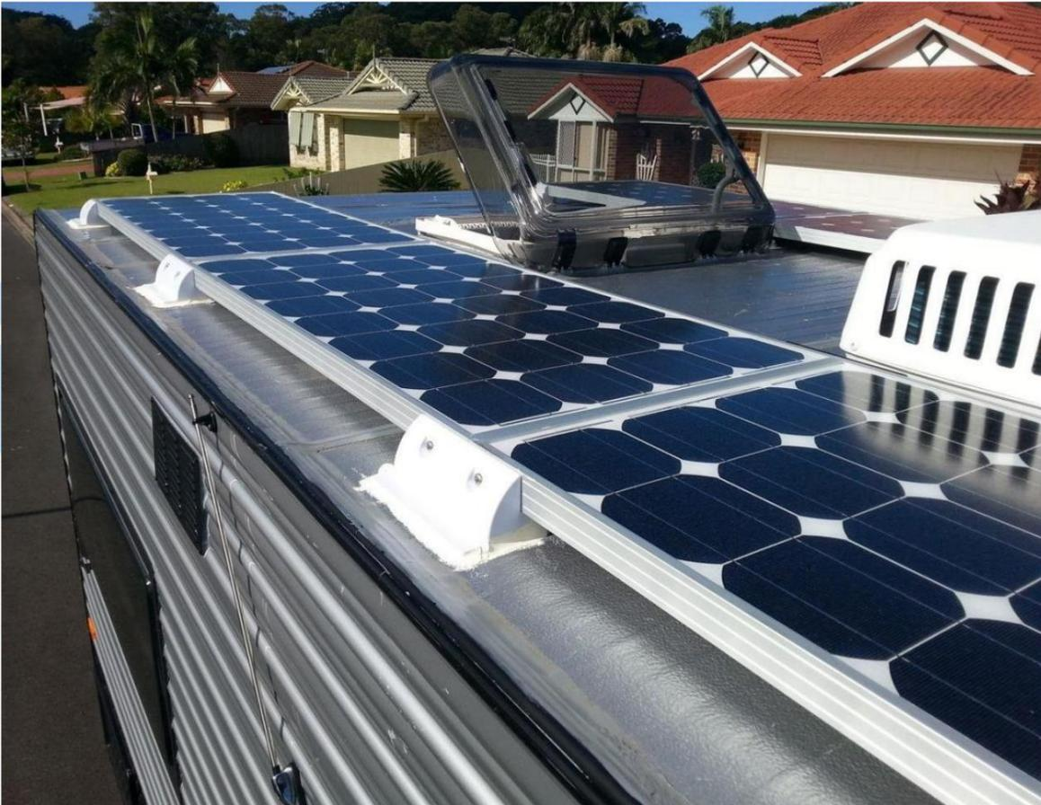
¡PELIGRO! La autocaravana debe guardarse en invierno, ya que en caso de heladas se puede acumular agua en los paneles solares y provocar daños.
