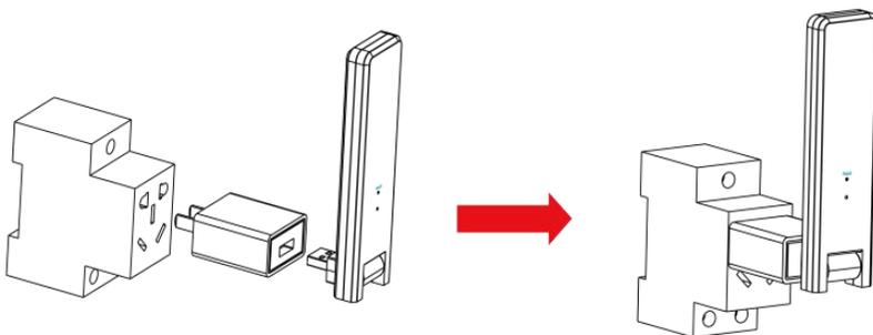
**Opción 2: Conecte la DTU al adaptador y conéctelo a la regleta. Asegúrese de que esté colocado al menos a 0,5 metros del suelo e intente instalar la DTU a 90 grados verticalmente del suelo tanto como sea posible.**
