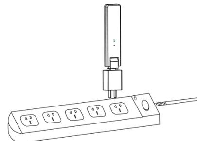
*Nota: No instale la DTU directamente sobre metal u hormigón para evitar la atenuación de la señal.*
